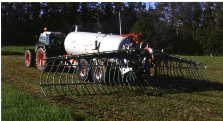
Distribuidor de xurros en superficie (FONTE: Bueno Lema J. 2006)
